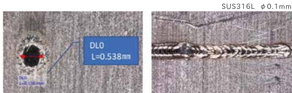
ビームが不安定: 汚いビード(溶接欠陥のおそれ)
