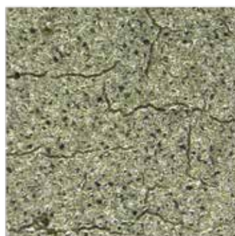
② 高硬度材料を溶接した際の割れの様子
