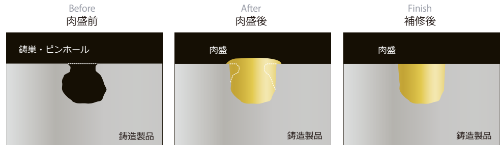
Fig.9 鋳造製品のピンホールへの肉盛工程
