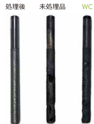
耐溶損試験8時間後
