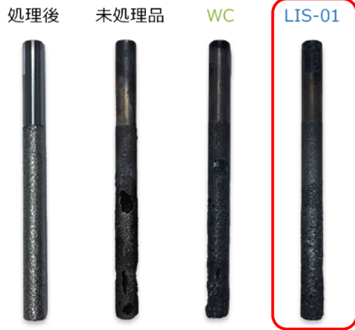
耐溶損試験8時間後
