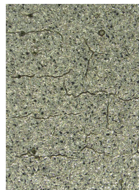
他社製: 割れ有り
