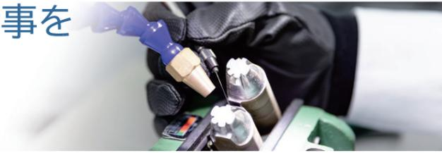
テラスレーザーの企業理念を具現化した製品が「T-LASER」です。低出力帯に特化したレーザー溶接システムとなり、パルス入力のため、ワークに熱をためません。母材に熱の悪影響（歪み・ヒケ・硬度変化等）を与えない高品質な溶接技術は、プラスチック・ダイカスト・プレス金型等の精密金型や高価な機械部品の肉盛補修にご利用いただいております。従来の溶接補修技術である TIG 溶接は熟練の技術が必要でした。T-LASER は低熱入力のため、高品質な精密溶接が誰でも簡単にできます。高齢化で熟練工が減少しても、T-LASER がカバーいたします。
